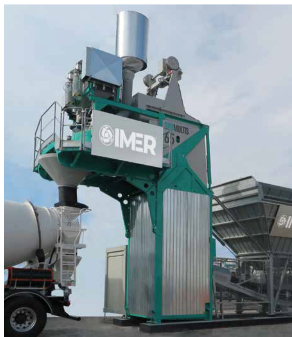
Unidad de Mezclado ORU MULTIS 55 con Skip de carga y cabina integrados, incluso durante el transporte
